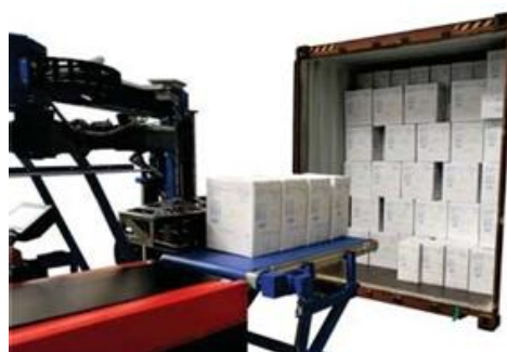
شکل ۲. سامانه اتوماسیون پیشرفته بارگیری و تخلیه کالاها
