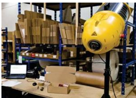
شکل ۱. ربات اسکن سه‌بعدی برای تعیین ابعاد محصولات و تولید کارتن‌های دقیق
