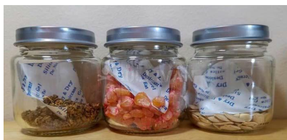
شکل ۲. استفاده از ژل سیلیکا برای حذف رطوبت هوا
