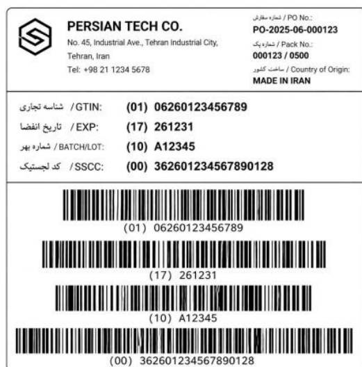
شکل (۸): تصویر برچسب استاندارد کلید شناسایی GS1-128
