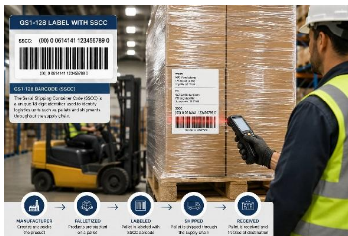
شکل (۲): پالت استاندارد دارای کد شناسایی SSCC
